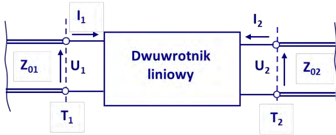
Rys. 5.1. Napięcia i prądy we wrotach dwuwrotnika.
