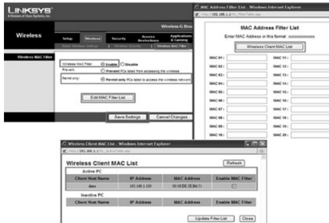
Rysunek 20. Konfiguracja filtrowania adresów MAC
