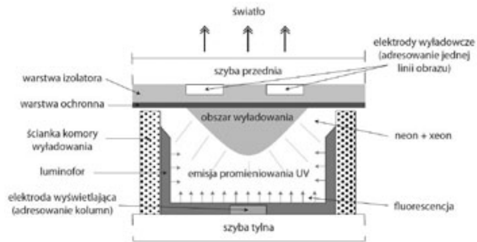
Rysunek 26. Konstrukcja pojedynczego piksela wyświetlacza plazmowego
