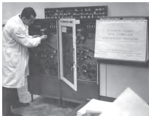
Rysunek 1. Komputer Elliott 803: jego schemat logiczny i programiści w czasie jego użytkowania
