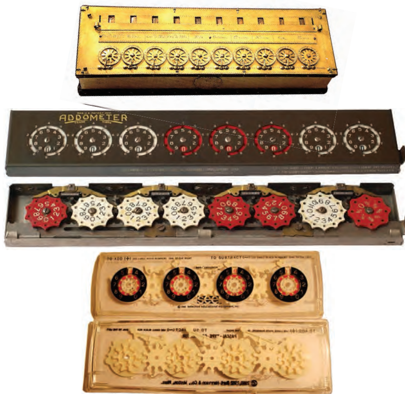
Rysunek 5. Pascalina ze zbiorów muzeum Salonu Aparatów Matematycznych i Astronomicznych (Zwinger) w Dreźnie; Addometer, późniejszy kalkulator zbudowany na idei Pascaliny – widok zewnętrzny i widok mechanizmu; Kalkulator See z widocznym mechanizmem dodawania i przenoszenia
