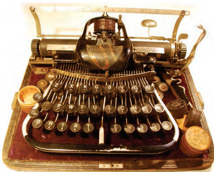
Rysunek 18. Maszyna do pisania Blickensderfer (USA, koniec XIX wieku), z wymiennymi główicami z czcionkami (w drewnianych pudełkach) oraz klawiaturą Morse’a
