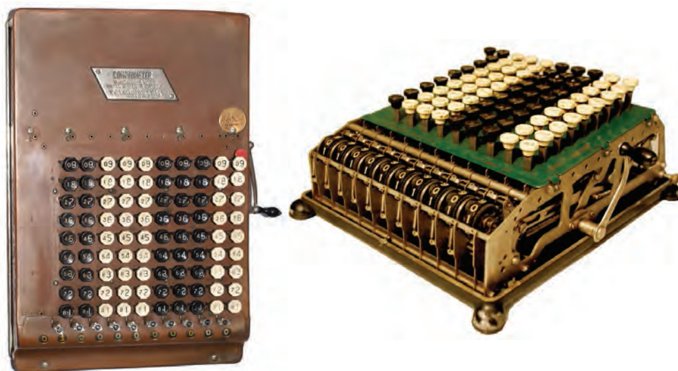
Rysunek 14. Wczesne kalkulatory pełnoklawiaturowe: Comptometer i Burroughs model 5 (z odsłoniętym mechanizmem)
